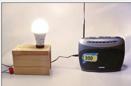
Figuur 31. EMC-test met FM-radio.
